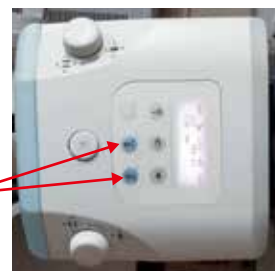
※限束器上搭载の影像系统 (X射线球管·FPD) 操作开关
